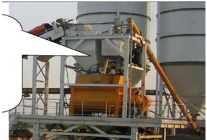
Hệ thống phễu chờ vật liệu bên trên nôi trộn
